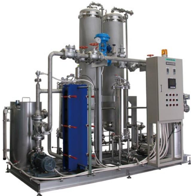
高精度の蒸気コントロール弁とプレート式熱交換器を使用した温水加熱方式の殺菌装置で、蔵内用と高精度詰口用の2タイプが有ります。原酒との熱交換による急冷方式も製作可能です。
