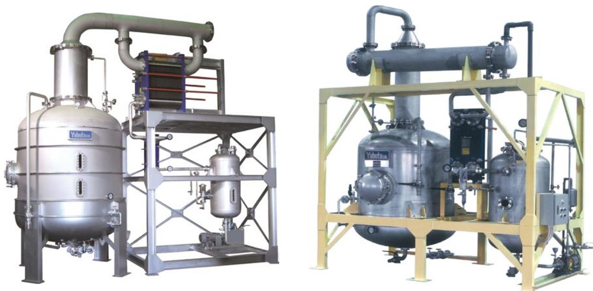
本減圧蒸留（濃縮）装置は、従来の常圧での単式蒸留装置と比較し、非常にソフトな風味・香気をそなえた蒸留アルコール飲料の製造に対応するように開発したものです
