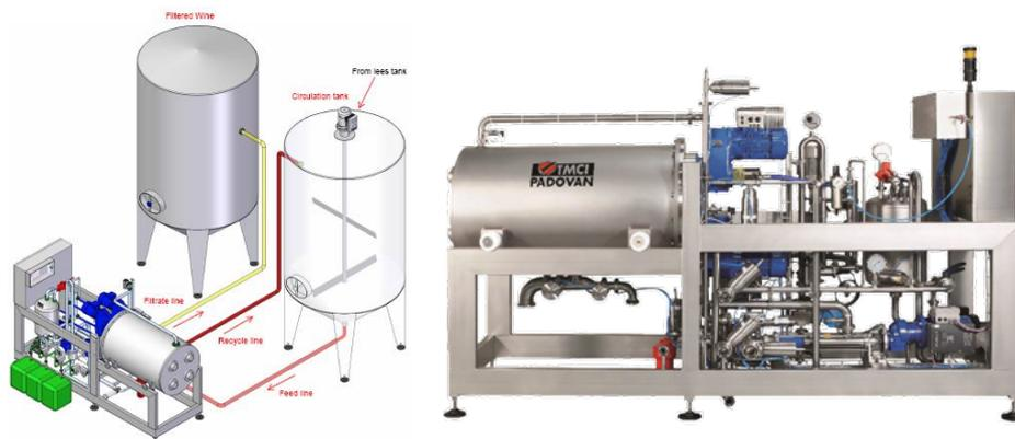
濾材は円盤型のセラミック製です。濾過室内でこの円盤型セラミックディスクが回転します。従って、従来のクロス・フロー濾過機より、より強力なタンジェントフローの発生です。しかも、濾盤が回転することで、モーターも従来のクロス・フローに比べずっとコンパクトです。清酒もろみ、30%、40%のSS分が含まれた液の濾過を可能にします。
