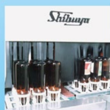
びん供給 / 排出部
