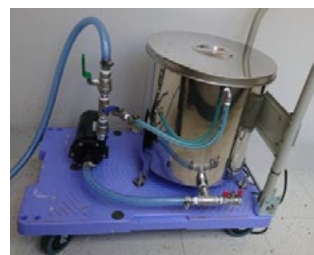
薬液注入ユニット
