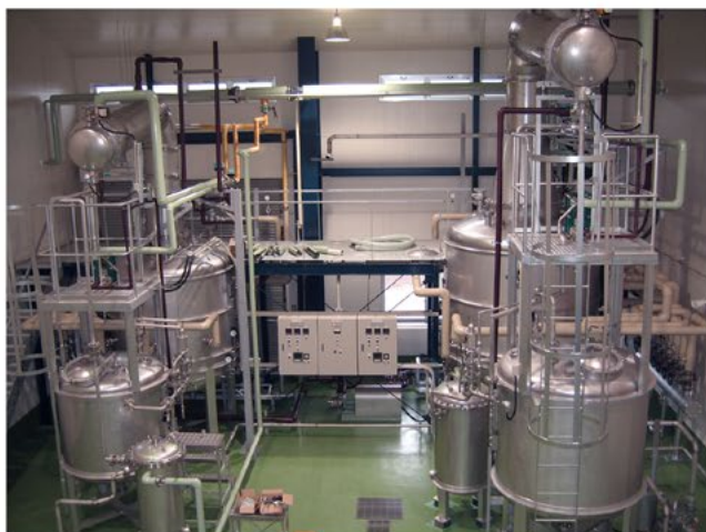
減圧蒸留機 Decompression distiller
