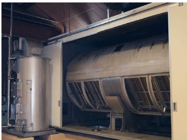
全自動40時間製麹ドラム Automatic 40hr Koji making drum
